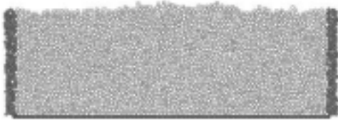
FIGURE 2-8 Exemple d'empilement granulaire périodique simulé par Dynamique des Contacts
