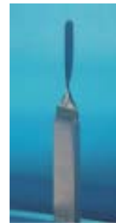
FIGURE 5-6 Rotation d'une fissure autour de la direction de propagation dans une éprouvette en PMMA chargée en flexion 4 points
