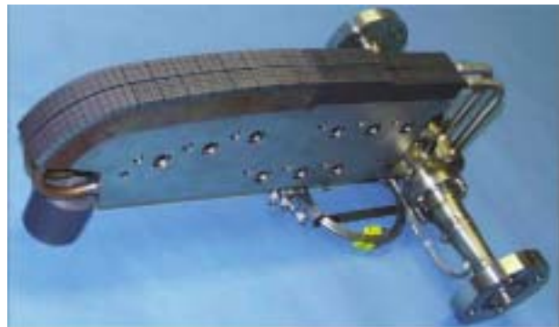
FIGURE 5-1 Aiguille formant le limiteur du réacteur de fusion Tore Supra. La partie supérieure plus sombre est composée de tuiles de CFC protégeant la partie métallique contenant le circuit de refroidissement.
