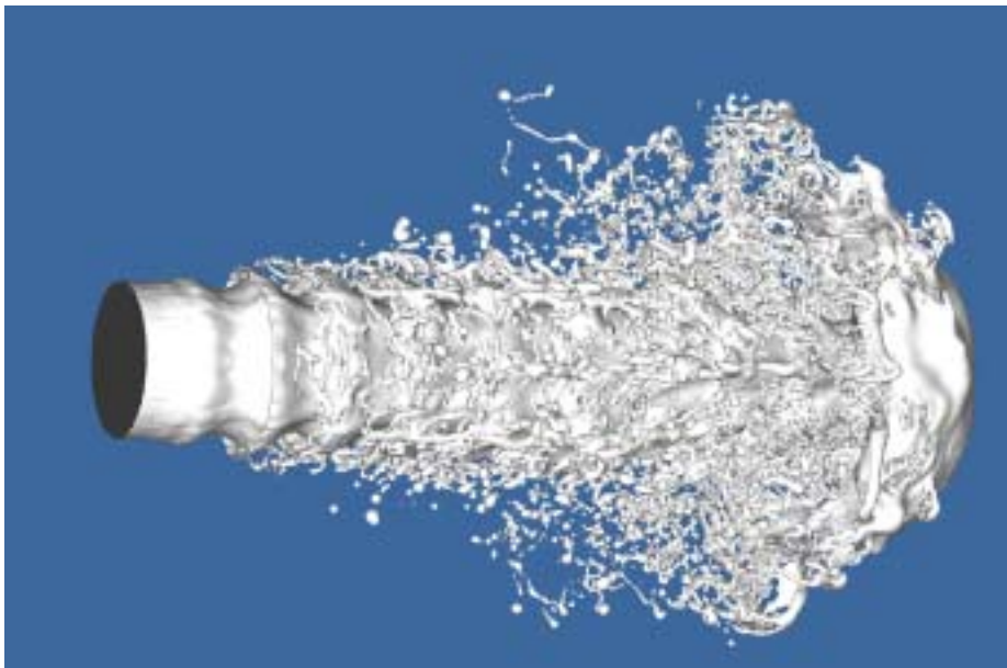
FIGURE 2-1 Simulation d'un jet d'atomisation Diesel sur maillage adaptatif hiérarchique .
