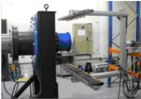
FIGURE 6-13 Scanner en U placé en sortie d'un convecteur d'air pour l'étude de la turbulence dans une rotation solide du flux d'air.
