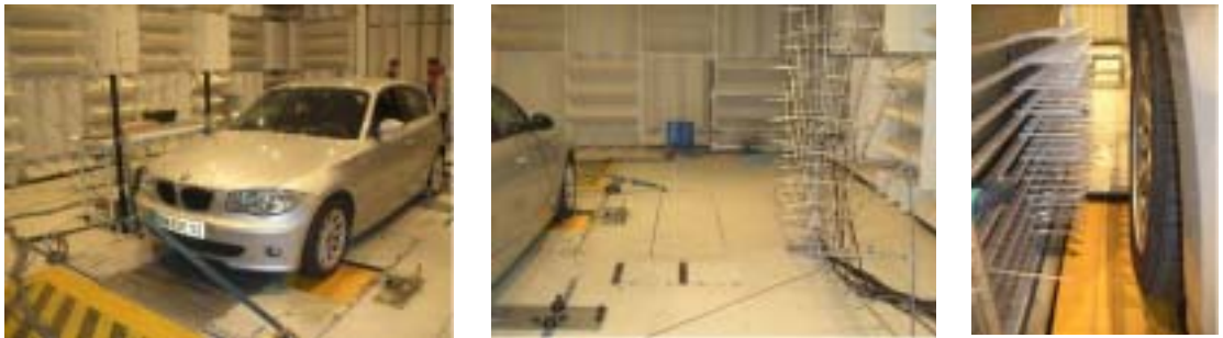
FIGURE 6-21 Expérience d'imagerie du bruit de roulement – Chambre Anéchoïque du CEVAA – Rouen – novembre 2006.
