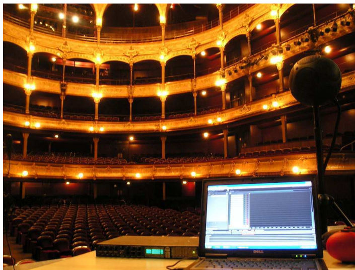
FIGURE 4.2 – Mesure de la réponse impulsionnelle dans le théâtre du Châtelet (Paris,2009).
