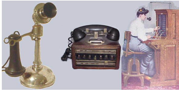
FIGURE 1.8 – Outils de télécommunication. De gauche à droite : Stromberg & Carlson Candlestick téléphone (1895-1896), Intercom Dictograph Products Company Inc, (USA, 1907-1913), Femme sur un Switchboard (1904).
