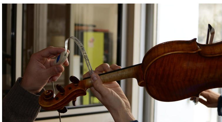
FIGURE 1.2 – Mesure de pression sous le pouce à l’aide d’un capteur FlexiForce
