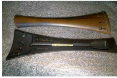
FIGURE 4.1 – Cordier avec masse ajustable monté sur un violon de l’expérience
